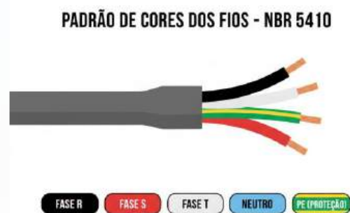
Figura 6 – Tabela de Cores de Cabos
